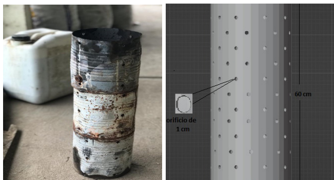
Figura 2. Prototipo de estufa de combustión controlada usada en el ensayo
