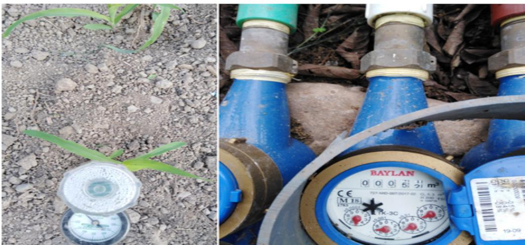
Figura 2. Equipo utilizado para el funcionamiento del sistema de riego en el cultivo de maíz (*Zea mays* L.) híbrido duro PIONEER 30K75 irrigado a través de riego por goteo subsuperficial a 10, 20 y 30 cm de profundidad. A) Instalación y lectura de tensiómetros y B) Instalación y lectura de las válvulas volumétricas.
