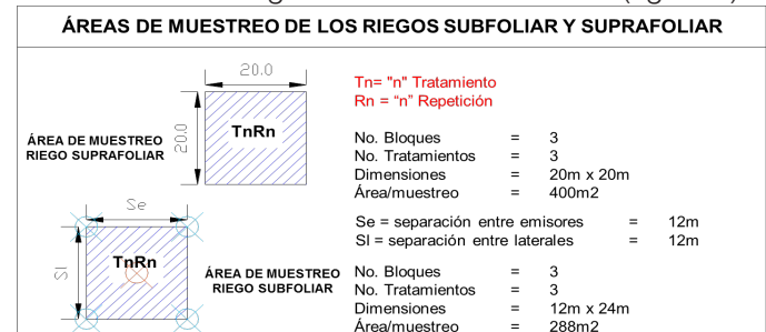
Figura 2. Dimensiones de las áreas de muestreo en los riegos subfoliar y suprafoliar de las fincas.
