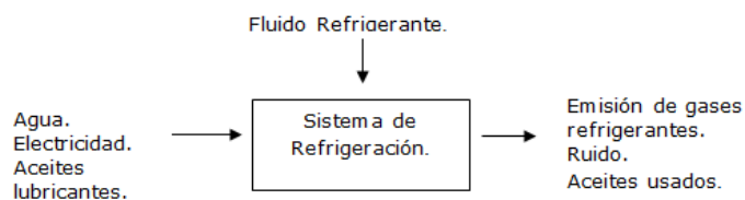
Figura 3. Generación de frío.
