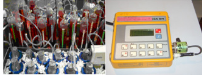
Figura 1. Esquema y foto del montaje experimental en discontinuo y analizador de gases.
