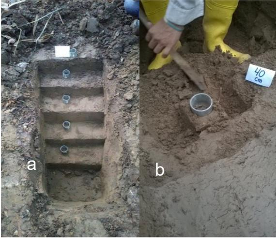
Foto 1. Detalles de la calicata, a. Construcción de calicata. B. Toma de muestra para análisis físico del suelo.
