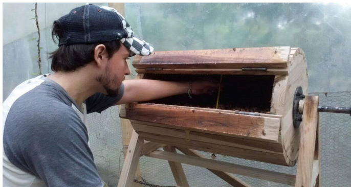
Figura 1. Prototipo del Rotor de madera usado para la fermentación de granos de cacao.
